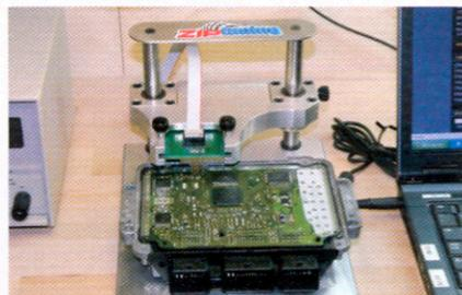
Voici comment se présente un calculateur démonté. Il comporte une prise permettant de le reprogrammer.
