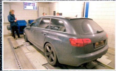
Le passage au banc avant et après transformation d'un moteur est obligatoire pour valider le travail du préparateur. Cette RS6 revue par Ziptuning est passée à 642 ch et 931 Nm de couple !
