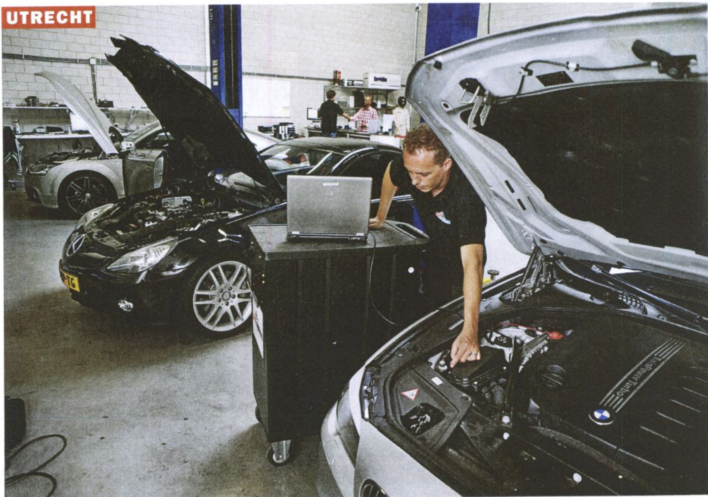
Kevin Kalkman van ZIP Tuning leest de software uit van een BMW 5. Klanten komen van heinde en verre om hun auto meer trekkracht te geven
