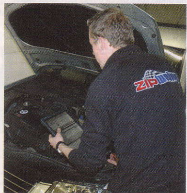
Na de downtuning wordt het motormanagement nog even uitgelezen.
